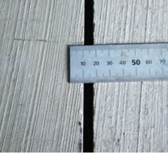
曲げ試験により誘導目地に沿って発生した外周部のクラック
