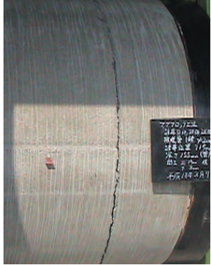
曲げ試験により誘導目地に沿って発生した外周部のクラック
