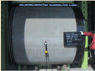
曲げ試験載荷前
