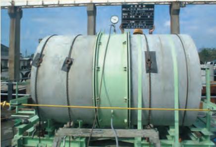
外水圧水密試験装置の全景(呼び径1350)
