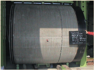
曲げ試験載荷後の破断状況
