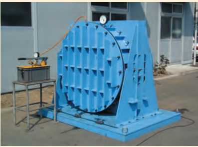
内水圧水密試験装置の全景(呼び径1350)
