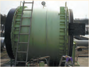
曲げ試験後の外水圧水密試験
