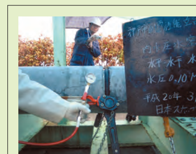
水平水密試験(30-30mm) 内水圧 0.10MPa
