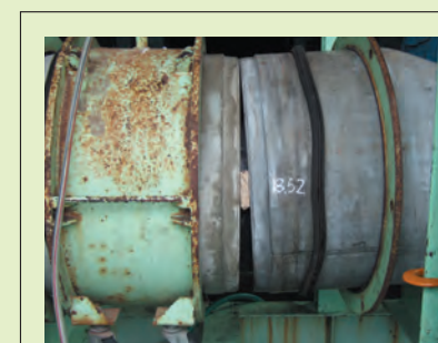
曲げ水密試験 (0-37mm)
