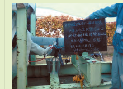
複合水密試験(30-42mm) 内水圧 0.10MPa
