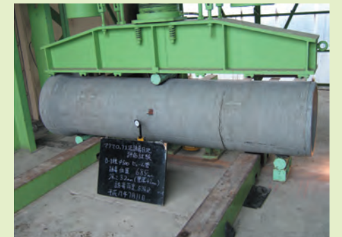
誘導目地に沿った破断の確認(φ500)
