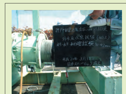
外水圧 0.10MPa 複合水密試験 (30-42mm)
