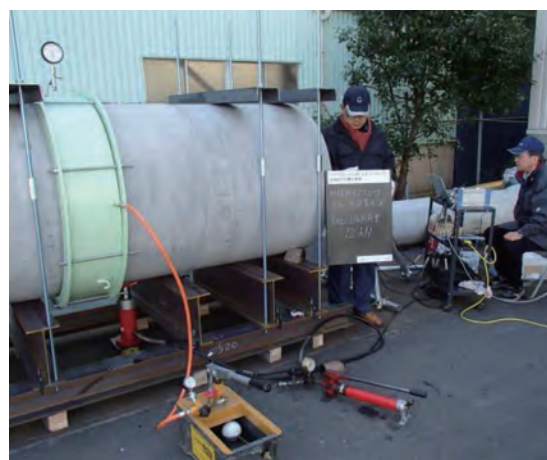
施工後の目地横ズレ時の水密性確認試験状況
